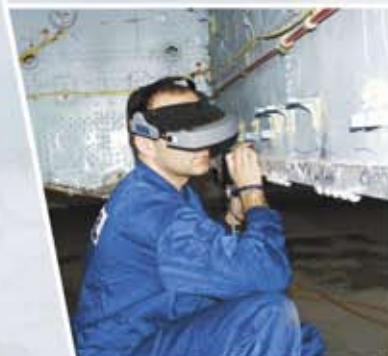
Ultradźwiękowe badanie struktury statku powietrznego
